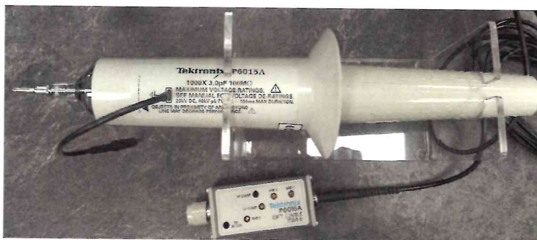
Рисунок 1.3 – Фотография пробника P6015A № C069701 осциллографа с цифровым люминофором DPO7254C № C140350
