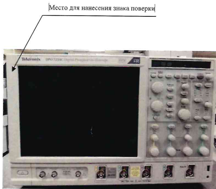
Рисунок 2.1 – Схема (рисунок) с указанием места для нанесения знака поверки осциллографа с цифровым люминофором DPO7254C № С140350
