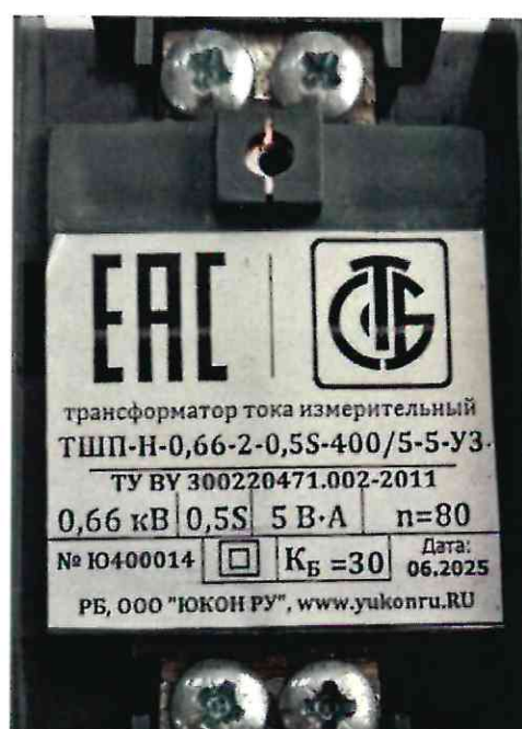
Рисунок 1.2 – Фотография маркировки трансформаторов тока измерительных ТОП-Н-0,66 и ТШП-Н-0,66 (изображение носит иллюстративный характер)
