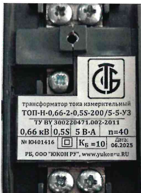
Рисунок 1.2 – Фотография маркировки трансформаторов тока измерительных ТОП-Н-0,66 и ТШП-Н-0,66 (изображение носит иллюстративный характер)
