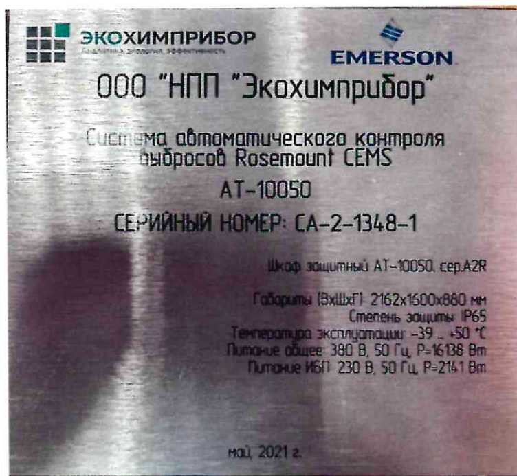
г) маркировка шкафа
