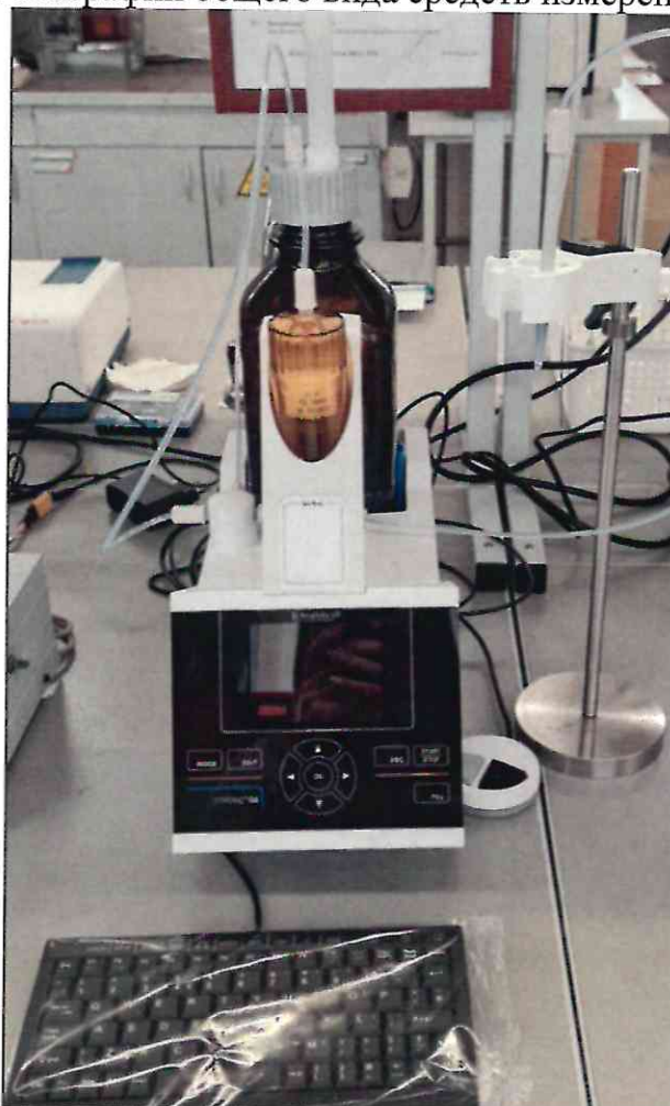
Рисунок 1.1 – Общий вид бюретки поршневой TITRONIC® 500 № 10000934
