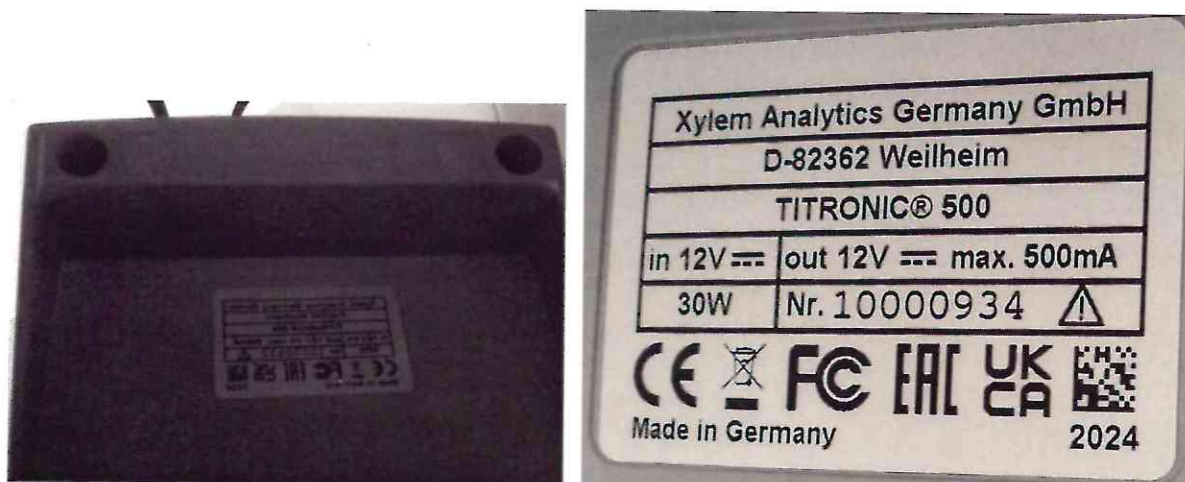
Рисунок 1.2 – Маркировка бюретки поршневой TITRONIC® 500 № 10000934
