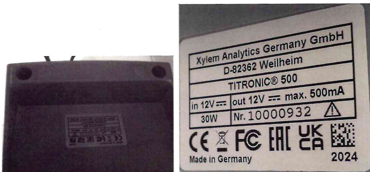
Рисунок 1.2 – Маркировка бюретки поршневой TITRONIC® 500 № 10000932
