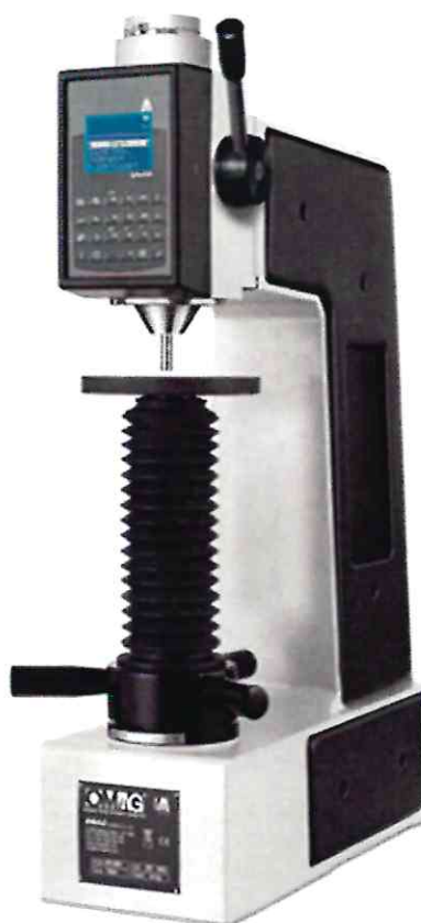
Рисунок 1.1 – Общий вид микротвердомера AFFRI MICRO IRHD № 76883
