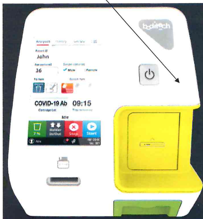
Рисунок 2 – Схема с указанием мест для нанесения знака поверки анализаторов иммунофлуоресцентных AFIAS
