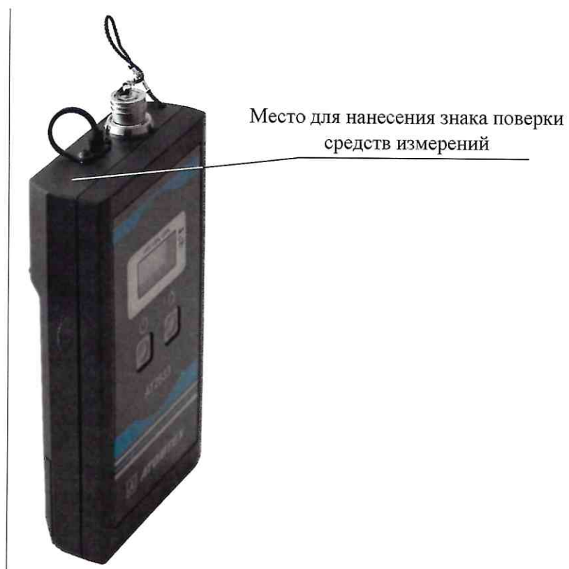
Рисунок 2.1 – Схема (рисунок) с указанием места для нанесения знака поверки средств измерений
