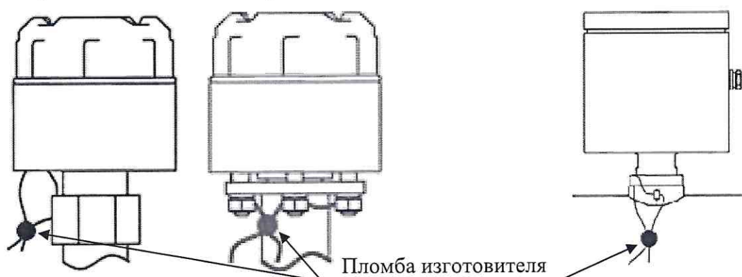
Рисунок 17 – Схема пломбировки ВП ЛУЧ-01 и ЛУЧ-02
