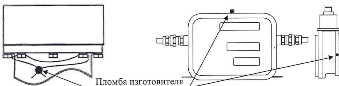
Рисунок 19 – Схема пломбировки ВП КУП+УСС
