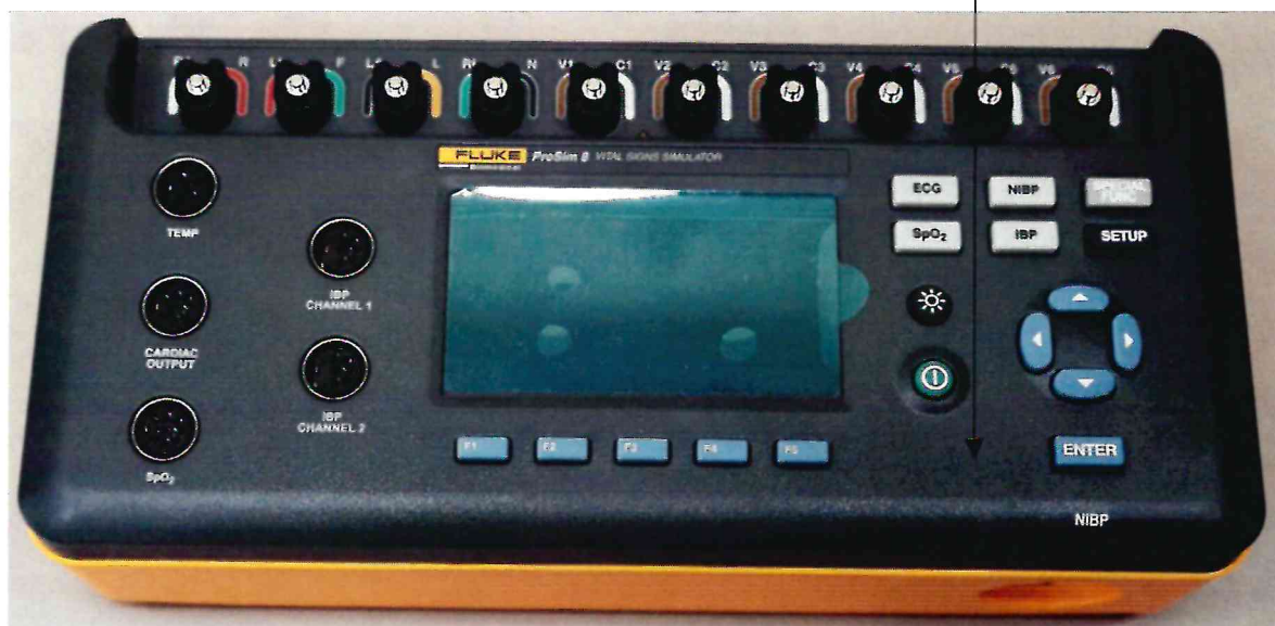
Рисунок 2.1 – Схема (рисунок) с указанием места для нанесения знака поверки на генератор сигналов пациента Fluke ProSim 8 № 6553073
