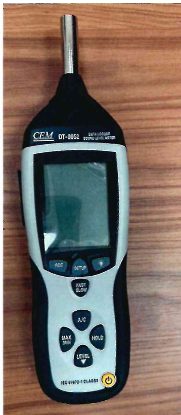
Рисунок 1.1 – Фотография общего вида измерителя уровня звука DT-8852 № 230737320
