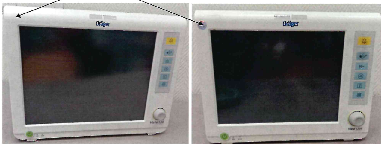
Рисунок 2.1 – Схема (рисунок) с указанием места для нанесения знака поверки
