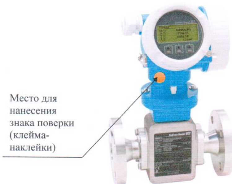
Рисунок 2 – Место для нанесения знака поверки (клейма-наклейки).
