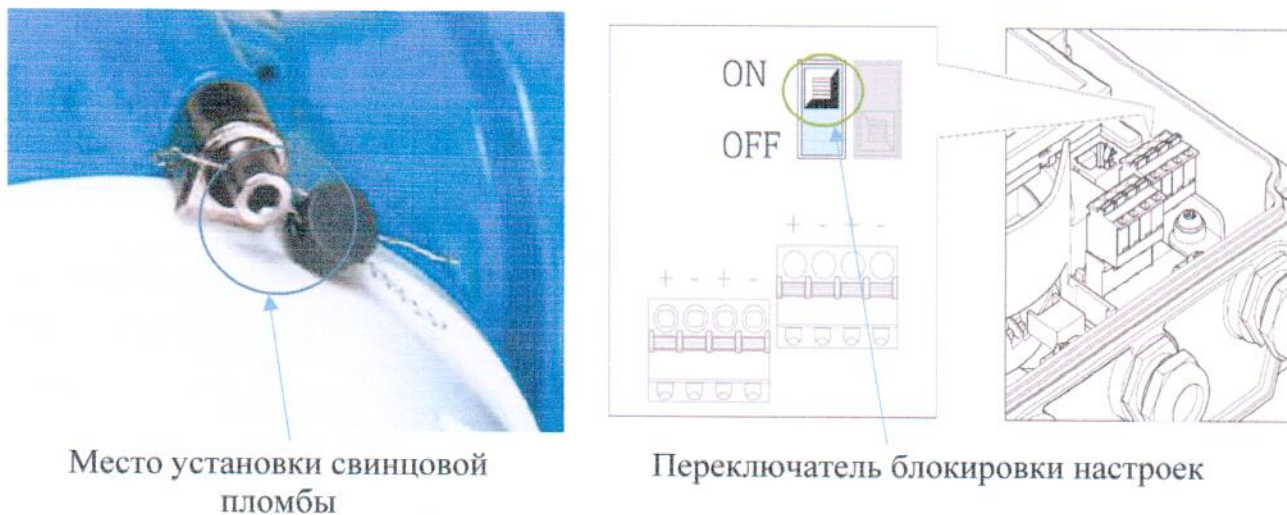
Рисунок 1 – Схема пломбировки от несанкционированного доступа
