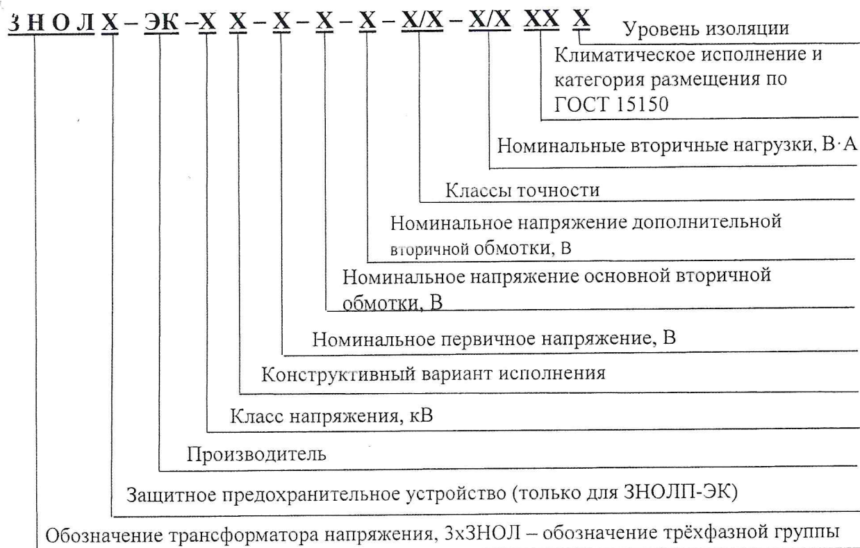
Рисунок 3 – Расшифровка условного обозначения трансформаторов напряжения
