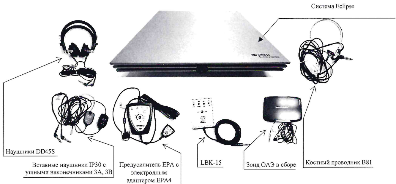
Рисунок 1.1 – Фотография общего вида системы для регистрации слуховых вызванных потенциалов и отоакустической эмиссии Eclipse
