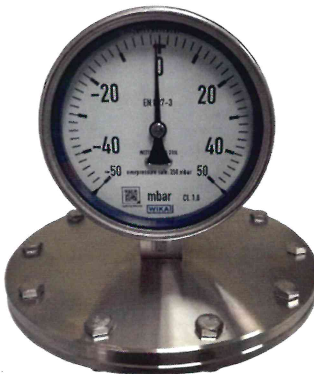
Рисунок 1.1 – Фотография общего вида манометра WIKAI 432.50.100 № 1A03QZNNSK6
