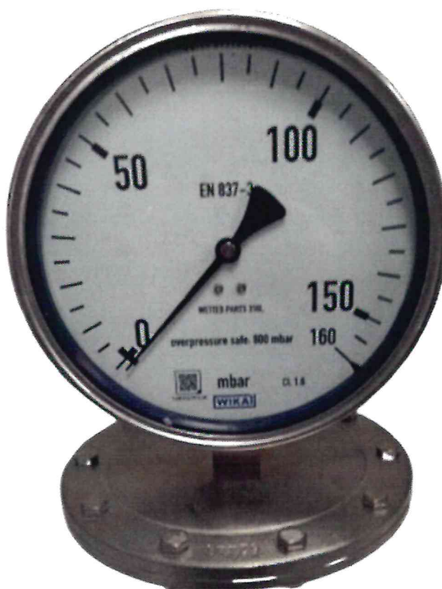
Рисунок 1.1 – Фотография общего вида манометра WIKА 432.50.160 № 1А03QZ5UI3К
