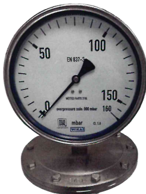
Рисунок 1.1 – Фотография общего вида манометра WIKAI 432.50.160 № 1A03QZ5SK3K
