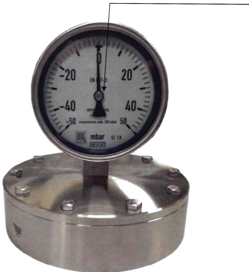
Рисунок 2.1 – Схема (рисунок) с указанием места для нанесения знака поверки средств измерений
