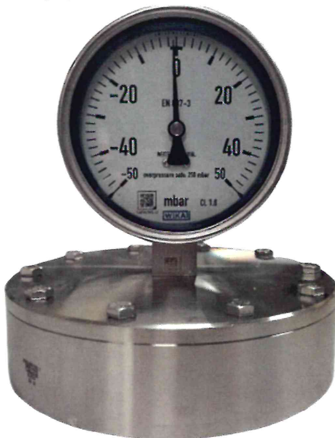
Рисунок 1.1 – Фотография общего вида манометра WIKA 432.50.100 № 1A03QZNRL42
