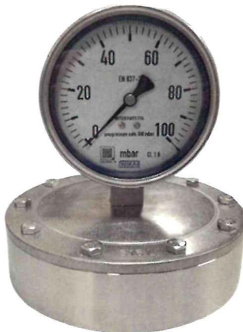
Рисунок 1.1 – Фотография общего вида манометра WIKKA 432.50.100 № 1A03QWGCTJM
