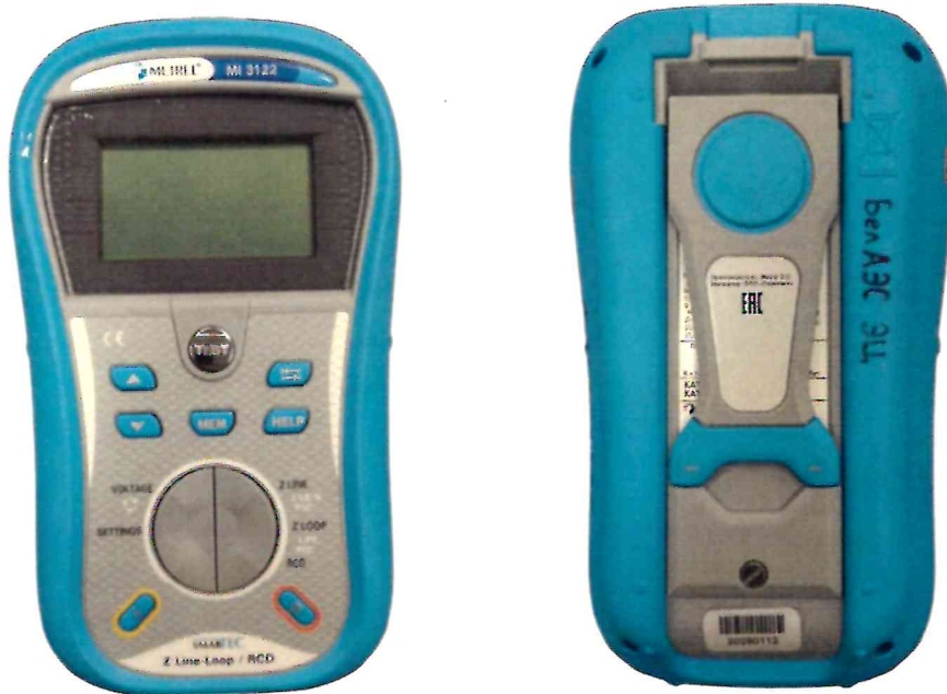
Рисунок 1.1 – Фотография общего вида измерителя полного сопротивления линии, контура и параметров УЗО MI 3122 № 20290112
