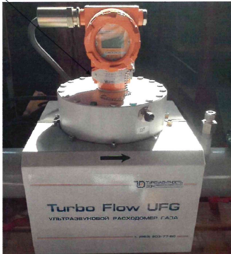
Рисунок 3.1 – Схема пломбировки от несанкционированного доступа
