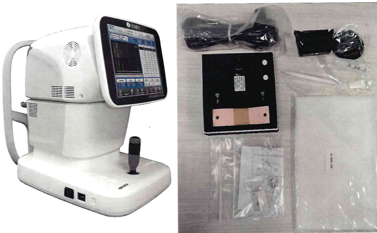
Рисунок 1.1– Фотография общего вида биометра офтальмологического: биометра оптического ОА-2000 с принадлежностями (изображение носит иллюстративный характер)
