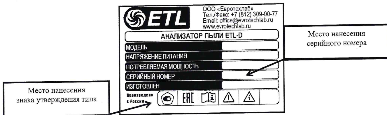
Рисунок 2 – Пример таблички (места нанесения знака утверждения типа и серийного номера)
