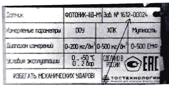
в) общий вид маркировочной таблички датчика ФОТОНИК-ПД-М1 с заводским номером
