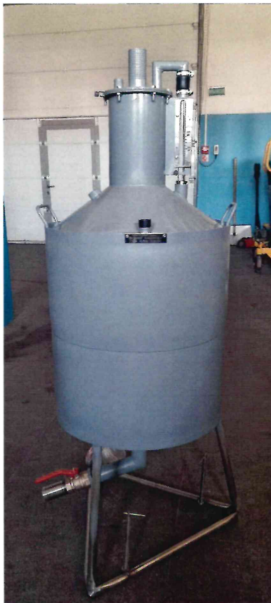
Рисунок 1.1 – Фотография общего вида мерника металлического эталонного 2-го разряда М2р-100-03 № 1035
