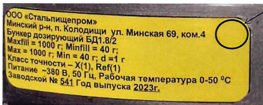
Рисунок 2.1 – Фотография с указанием места нанесения знака поверки (наклейки) на маркировочную табличку бункера дозирующего БД1.8/2 № 541
