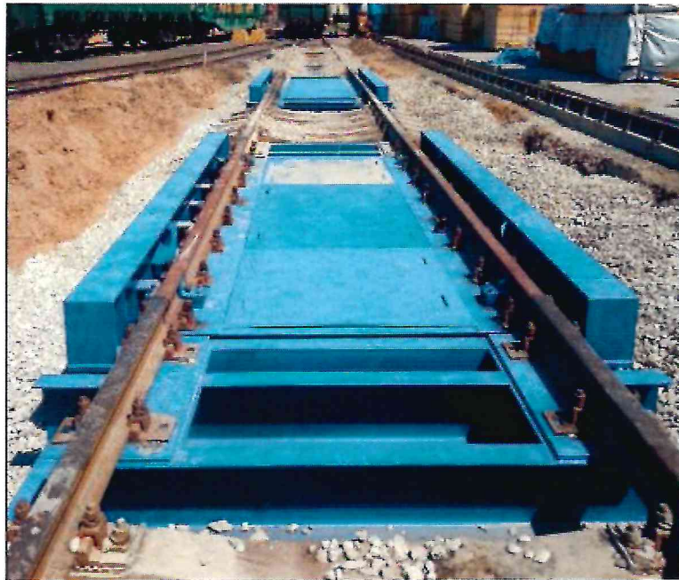
Рисунок 1.1 – Фотография общего вида весов вагонных электронных ВВЭС бесфундаментных на щебёночном основании с двумя платформами (изображения носят иллюстративный характер)
