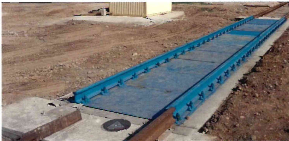
Рисунок 1.1 – Фотография общего вида весов вагонных электронных ВВЭС бесфундаментных на щебёночном основании с двумя платформами (изображения носят иллюстративный характер)
