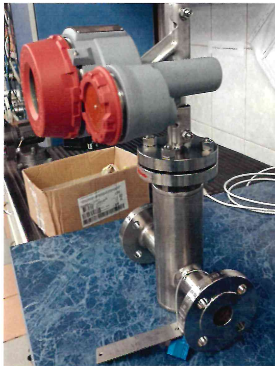
Рисунок 1.1 – Фотографии общего вида расходомера поплавкового MTF-B3W4/4iDC № 240800351
