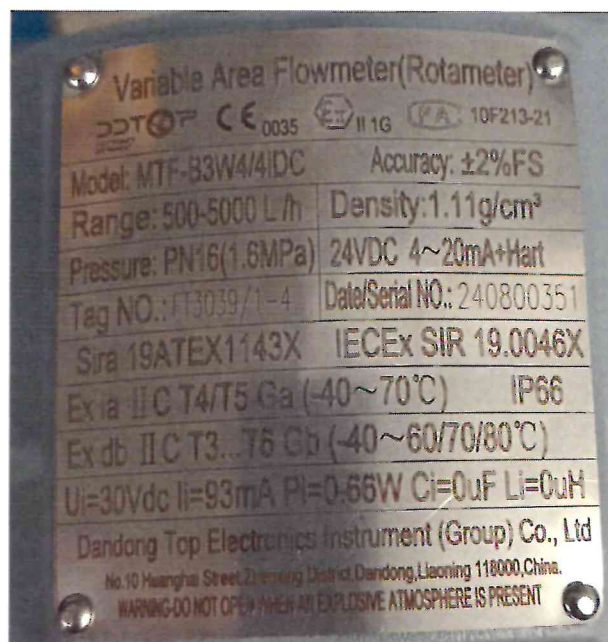
Рисунок 1.2 – Фотография маркировки расходомера поплавкового MTF-B3W4/4iDC № 240800351
