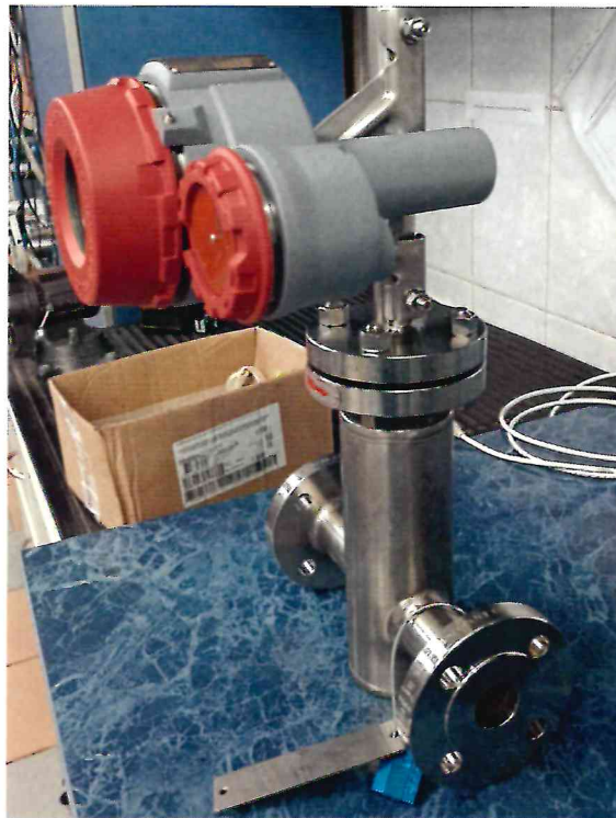
Рисунок 1.1 – Фотографии общего вида расходомера поплавкового MTF-B3W4/4iDC № 240800348
