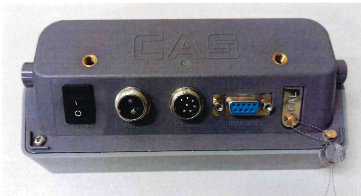
Рисунок 3.1 – Фотография с указанием места установки свинцовой пломбы дозирующего комплекса ДК(м)-54 № 1094
