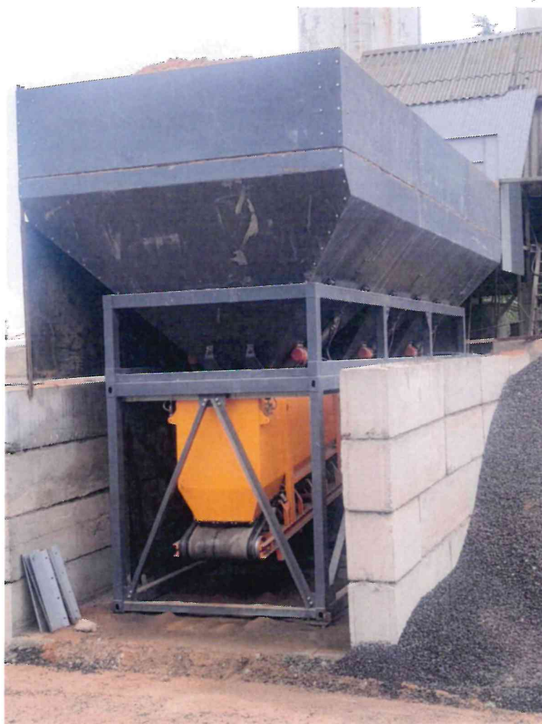
Рисунок 1.1 – Фотография узла дозирования дозирующего комплекса ДК(м)-54 № 1094
