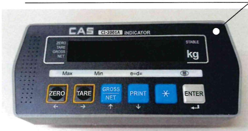
Рисунок 2.1 – Фотография с указанием места для нанесения знака поверки (клейма-наклейки) дозирующего комплекса ДК(м)-54 № 1094
