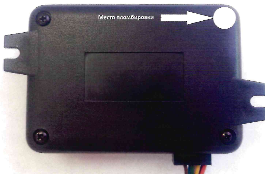
Рисунок 3.1 – Схема пломбировки от несанкционированного доступа комплексов мониторинга транспортных средств «ТрансНавигатор ТН-12/24 2G, 3G, LTE»
