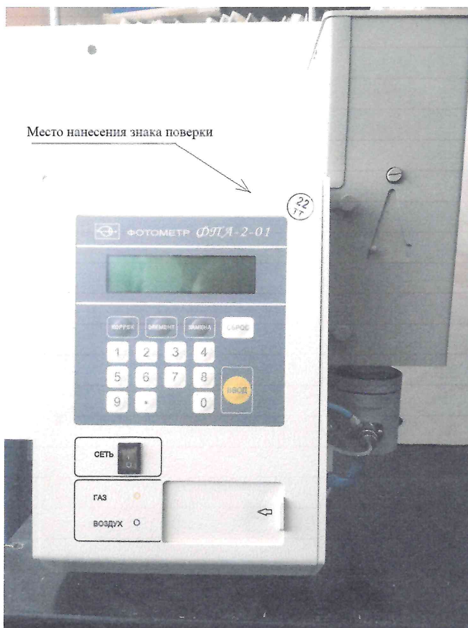
Рисунок 2.1. Схема (рисунок) с указанием места нанесения знака поверки средства измерений.
