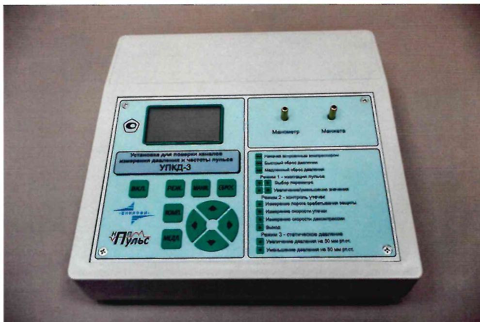
Рисунок 1.1 – Фотография общего вида установки для поверки каналов измерения давления и частоты пульса УПКД-3 № 000695 (изображение носит иллюстративный характер)
