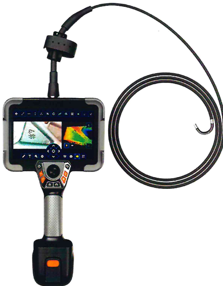
Рисунок 1.1 – Фотография общего вида видеоэндоскопа измерительного ET 3D PRO № 2025PRO35101
