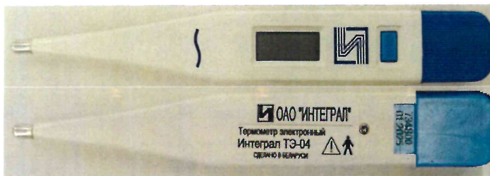
Рисунок 1 – Фотография общего вида и маркировки термометров электронных «Интеграл ТЭ-04» (изображение носит иллюстративный характер)
