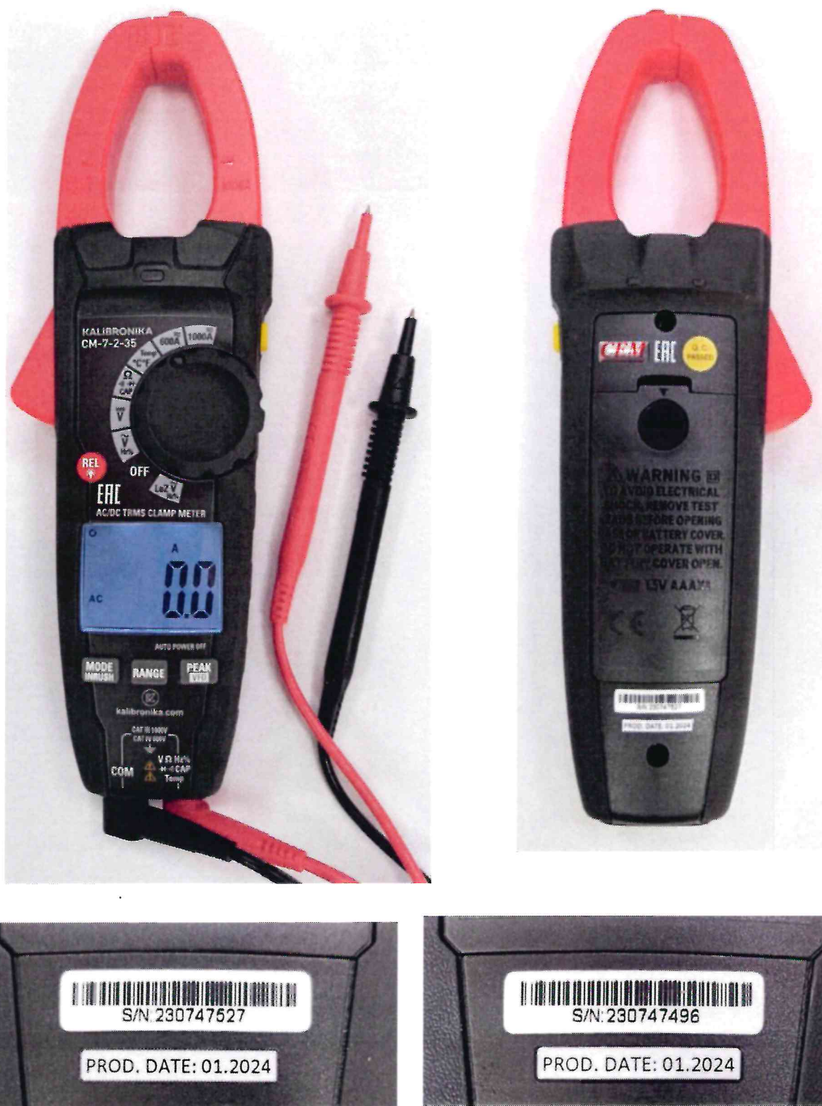
Рисунок 1.1 – Фотографии общего вида и маркировки клещей электроизмерительных KALIBRONIKA CM-7-2-35 (изображения носят иллюстративный характер)
