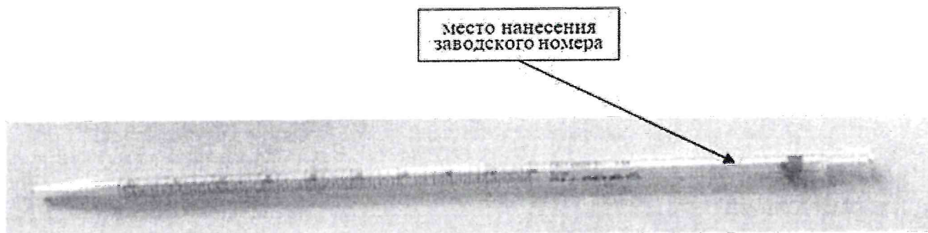
Рисунок 2 – Общий вид пипеток градуированных 1-го класса точности типа 2 с указанием мест нанесения заводского номера
