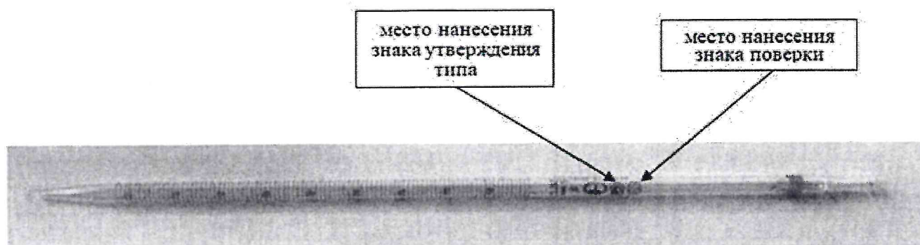
Рисунок 1 – Общий вид пипеток градуированных 1-го класса точности типа 2 с указанием мест нанесения знака утверждения типа и знака поверки
