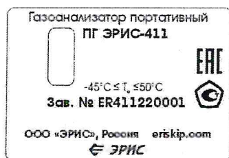
Рисунок 1 – Маркировочные таблички газоанализаторов портативных ПГ ЭРИС-411, ПГ ЭРИС-414 с указанием заводского номера и знака утверждения типа
