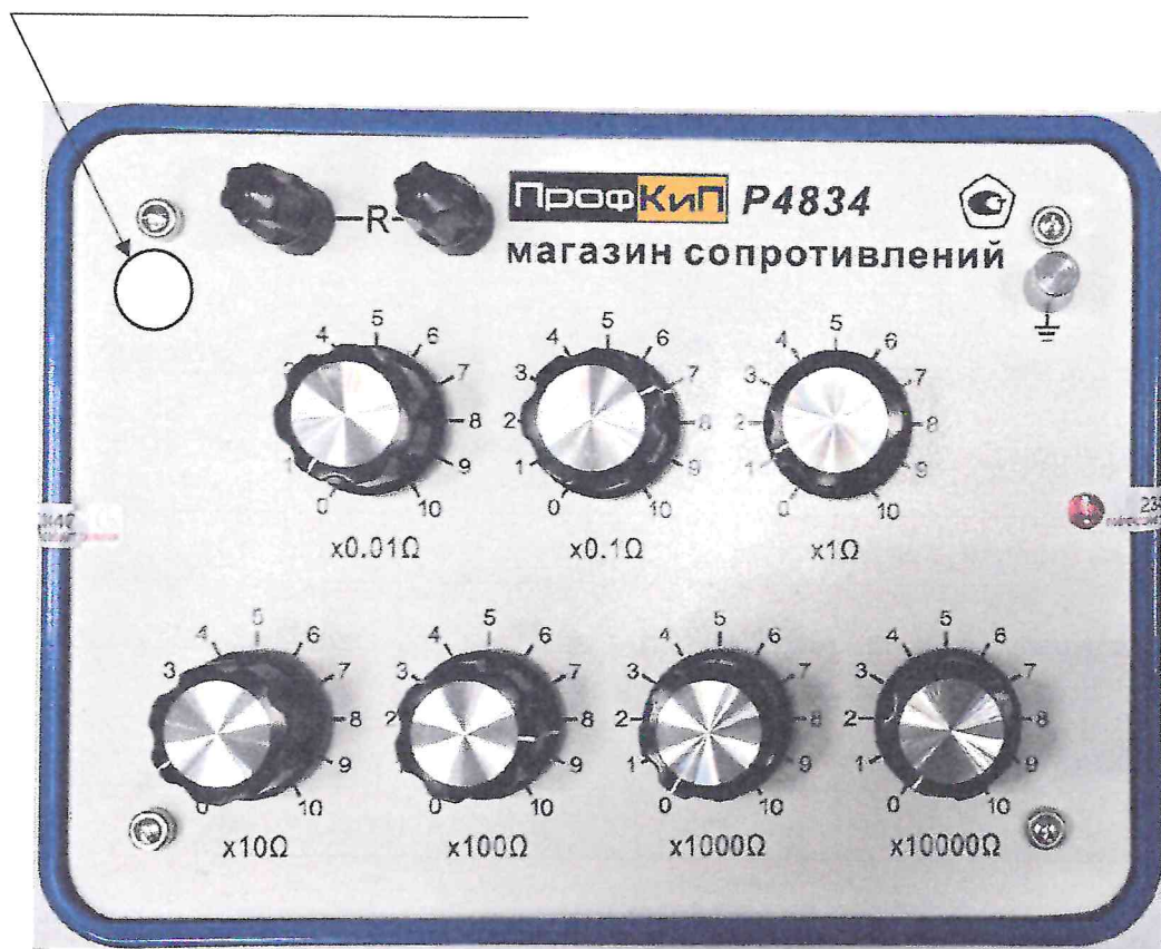
Рисунок 2.1. – Схема (рисунок) с указанием места для нанесения знака поверки магазина сопротивлений ПрофКиП Р4834 № В02305387.
