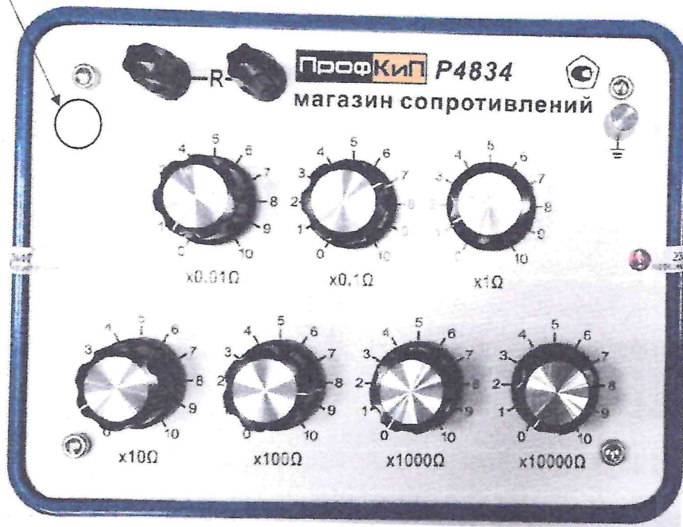
Рисунок 2.1. – Схема (рисунок) с указанием места для нанесения знака поверки магазина сопротивлений ПрофКиП Р4834 № В02305366.
