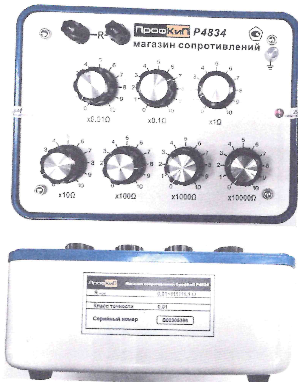
Рисунок 1.1. – Внешний вид магазина сопротивлений ПрофКиП Р4834 № B02305366.
