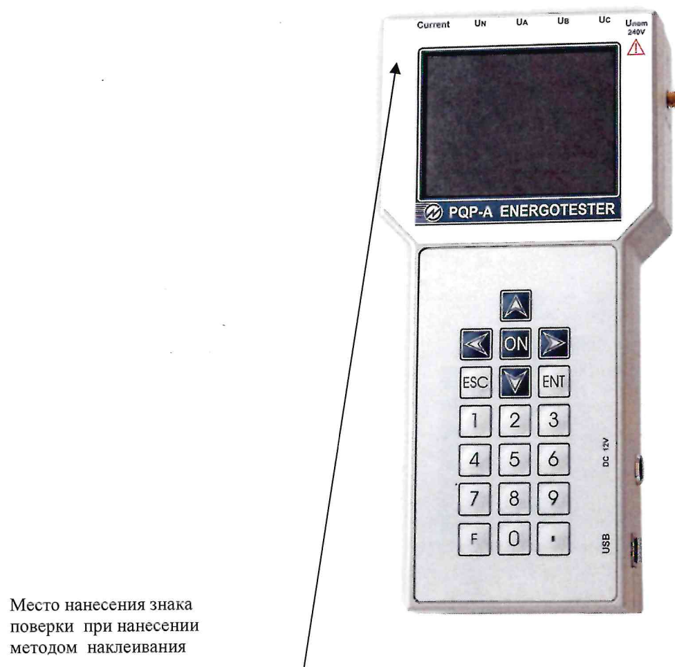
Рисунок 2.1 – Схема (рисунок) с указанием места для нанесения знака поверки на приборы для измерения показателей качества электрической энергии и электроэнергетических величин «Энерготестер ПКЭ-АМ»
