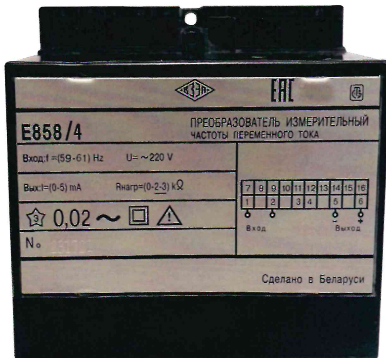
Рисунок 5 – Общий вид и маркировка ИП E858/4 для нужд народного хозяйства
