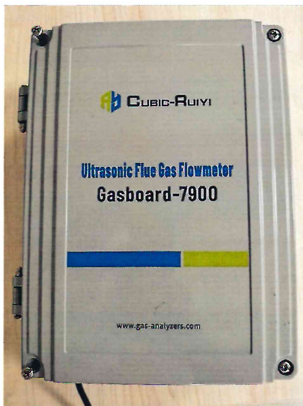
Рисунок 1.1 – Фотография общего вида блоков ультразвукового приемопередатчика измерителя скорости ультразвукового Gasboard-7900 № 232203150002
