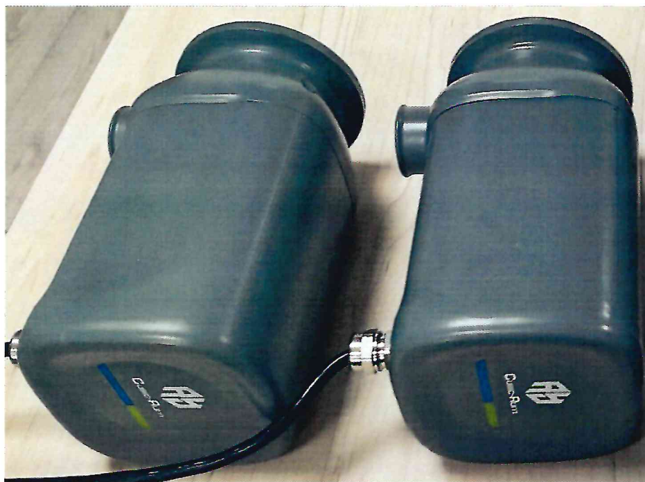
Рисунок 1.1 – Фотография общего вида блоков ультразвукового приемопередатчика измерителя скорости ультразвукового Gasboard-7900 № 232203150002
