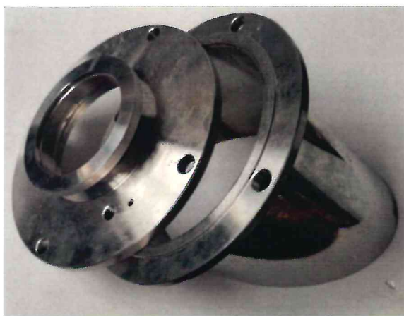
Рисунок 1.4 – Фотография общего вида ответного фланца измерителя скорости ультразвукового Gasboard-7900 № 232203150002
