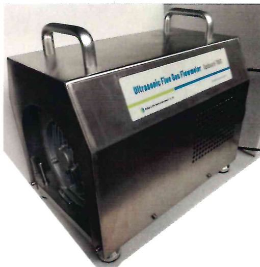
Рисунок 1.3 – Фотография общего вида вспомогательного оборудования для продувки измерителя скорости ультразвукового Gasboard-7900 № 232203150002
