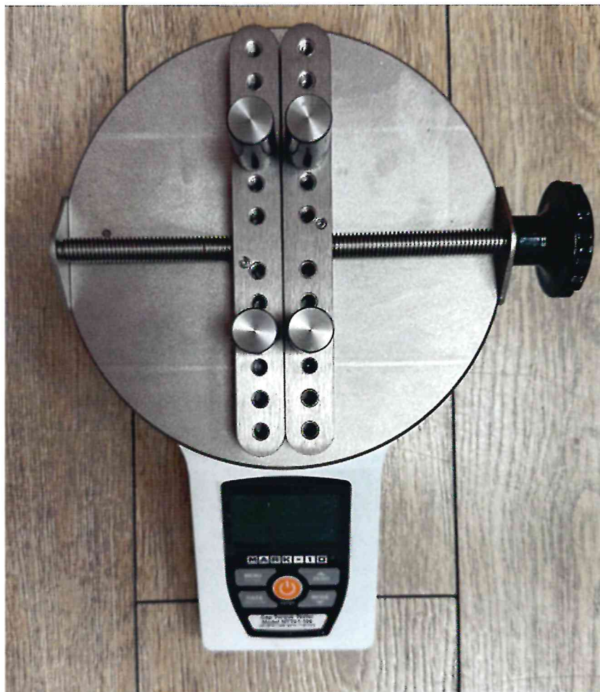
Рисунок 1.1 – Фотография общего вида цифрового измерителя крутящего момента крышек (торк-тестер) серия TT01 модель MTT01-100 № 4447162
