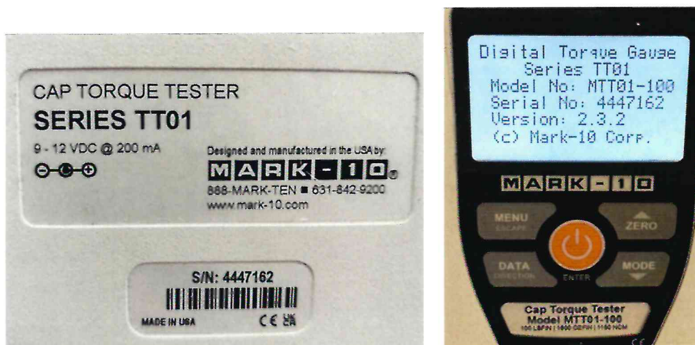
Рисунок 1.1 – Фотография общего вида цифрового измерителя крутящего момента крышек (торк-тестер) серия TT01 модель MTT01-100 № 4447162
