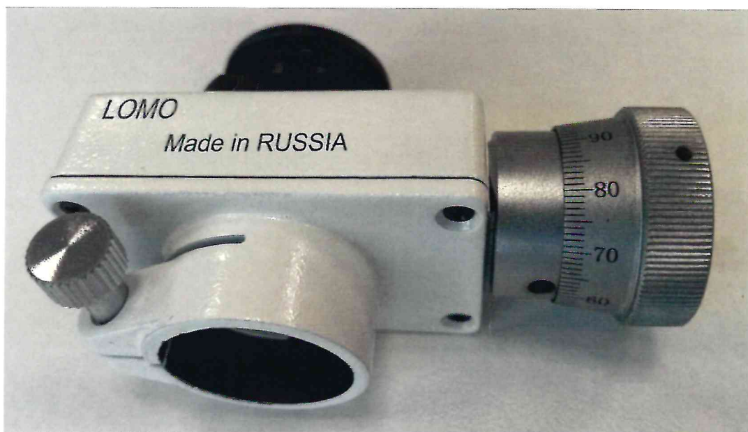
Рисунок 1.1 – Фотография общего вида микрометра окулярного винтового МОВ-1-16 х № 200292
