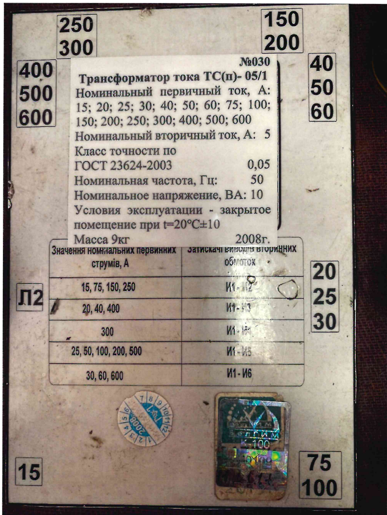
Рисунок 1.2 – Фотография маркировки трансформатора тока ТС(п)-05/1 № 030
