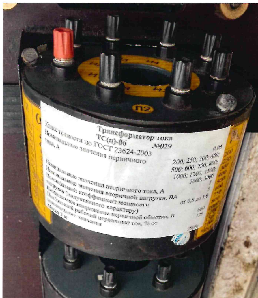
Рисунок 1.1 – Фотография общего вида трансформатора тока ТС(п)-06 № 029
