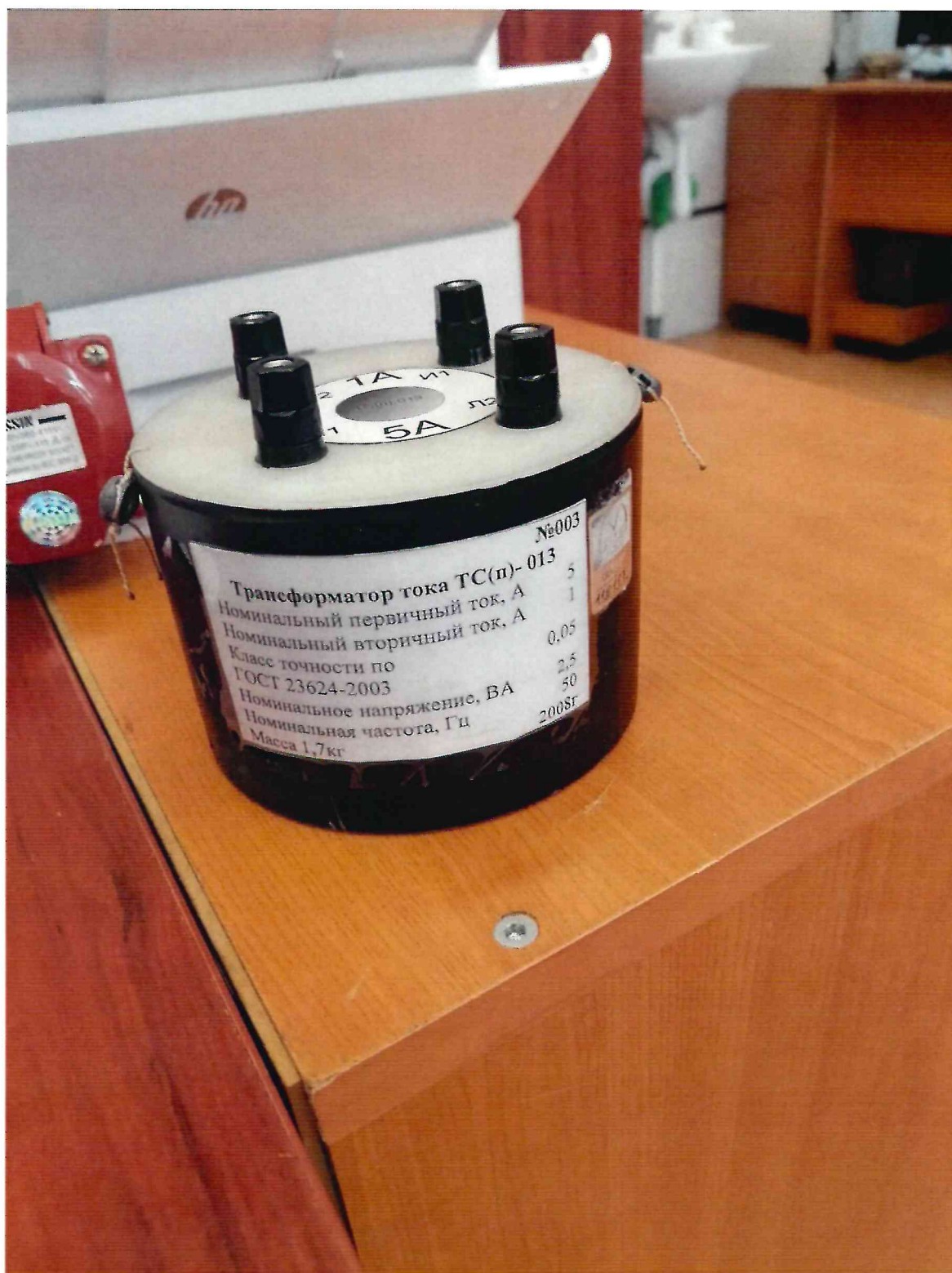
Рисунок 1.1 – Фотография общего вида трансформатора тока TC(p)-013 № 003
